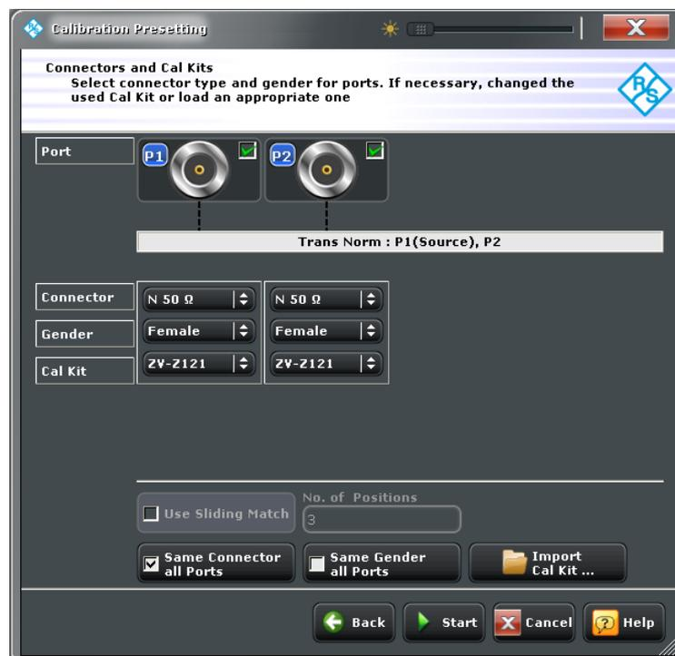
校准向导的下一个对话框中示出了需要测量的唯一一个校准标准。
