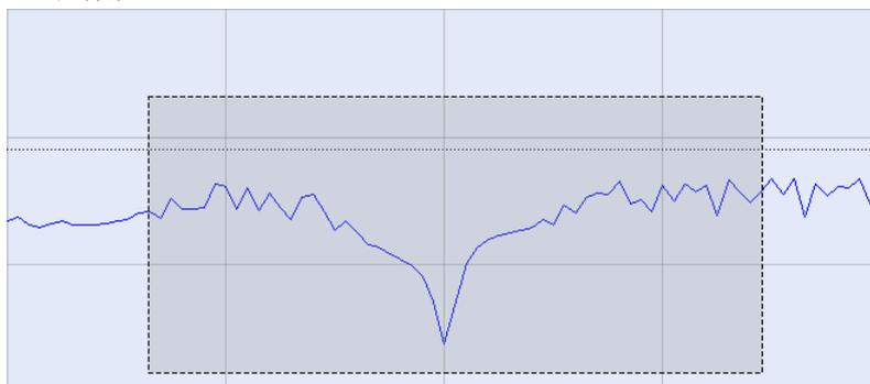
一旦在触摸屏上释放手指之后，缩放功能便会执行。缩放窗口会在水平与垂直两个方向进行缩放。一般来说，被缩放的图形中仅显示扫描范围中的一部分；所显示的扫描点之间的距离会变大。
