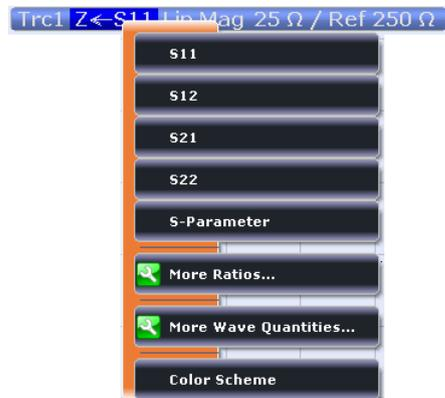
2. 轻触“S-Parameter (S-参数)”，然后打开“Meas (测量) > S-Params (S-参数)”触控工具面板。
